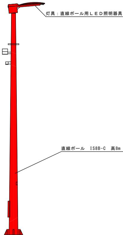
直線ポール IS8B-C 高8m ベース式 露出型 鋼製めっき
